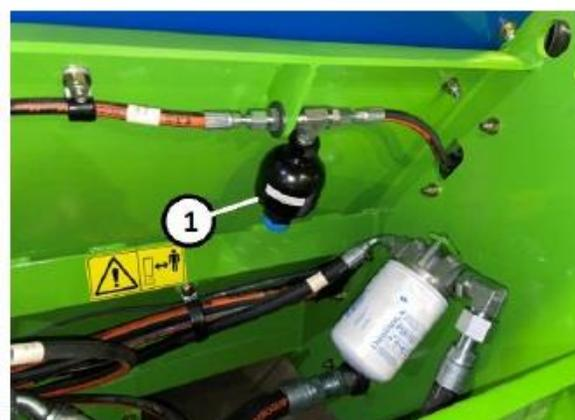
Figure 60. Emplacement de l'accumulateur
