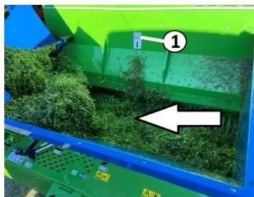
Figure 115. Débit de fourrage optimal au centre
