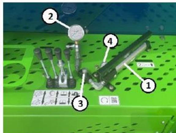
Figure 59. Commande du système de frein
