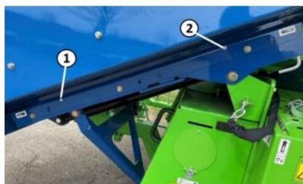
Fig. 145. Graissage des glissières du convoyeur
