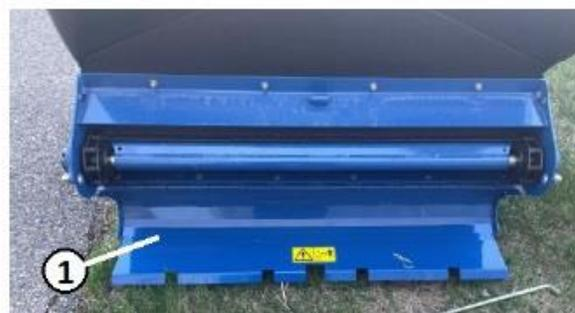
Figure 147. Porte de nettoyage ouverte
