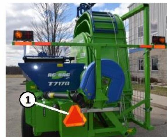
Figure 185. Triangle Véhicule lent (installé)
