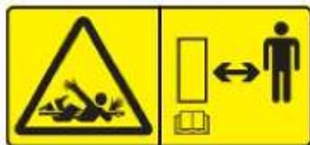
Autocollant de sécurité (5). Danger de happement. Cet autocollant concerne les pièces en rotation pouvant happer une personne. Tenez toute partie du corps et de vêtement à une distance sécuritaire de la machine en marche. Arrêtez la machine avant de faire l'entretien de la machine.
