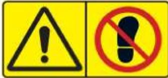
Autocollant de sécurité (9). Cet autocollant avertit qu'une surface en particulier ne doit pas servir de marche. Pour éviter un danger, ne posez pas le pied sur cette surface. Le non-respect de cet avertissement peut causer de graves blessures.
