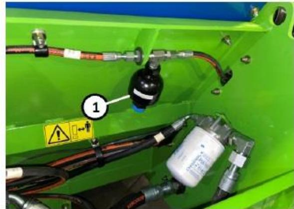
Figure 137. Emplacement de l'accumulateur
