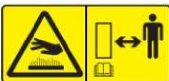
Autocollant de sécurité (7). Ce symbole avertit des risques de brûlures au contact de surfaces à haute température. Tenez-vous éloigné de cette zone lorsque la machine est en marche ou a été utilisée récemment, pour éviter des brûlures. Le non-respect de cet avertissement peut causer de graves blessures.
