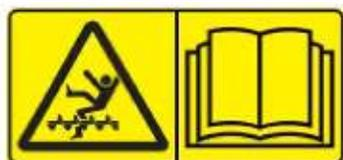
Autocollant de sécurité (6). Danger de happement par le rotor ou la vis sans fin. Cet autocollant concerne les pièces en rotation pouvant happer une personne. Arrêtez la machine avant de faire l'entretien de la machine dans cette zone.
