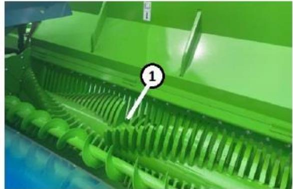
Fig. 62. Inspection de la barre racleuse
