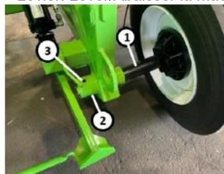
Fig. 86. Installer la fusée d'essieu (pos. travail)
