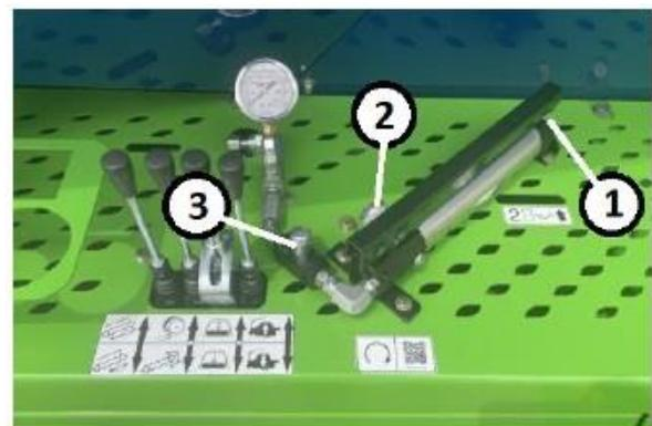
Figure 162. Pompe manuelle du système de frein
