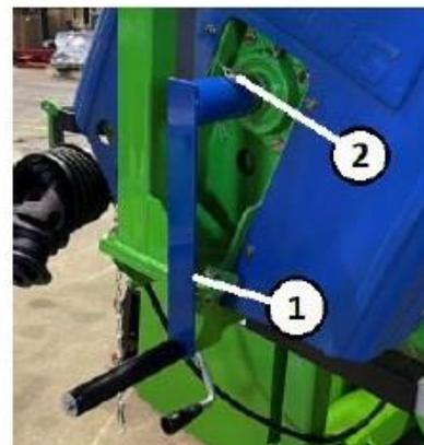
Figure 52 - Manivelle de rembobinage
