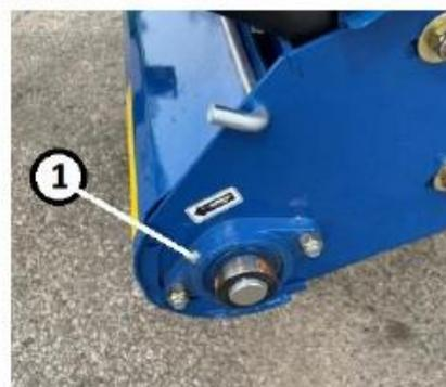
Fig. 144. Graissage du roulement inférieur
