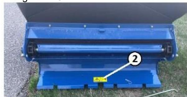
Figure 8. Porte de nettoyage du convoyeur
