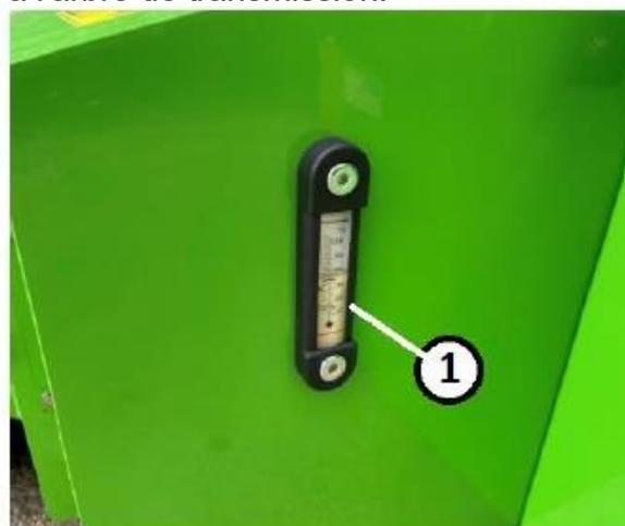
Fig. 154. Niveau du réservoir d'huile hydr.
