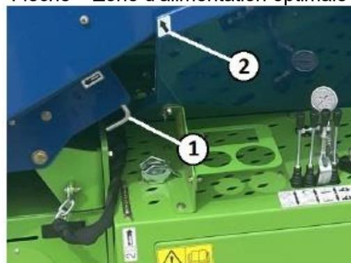
Figure 120. Verrou de levage du convoyeur
