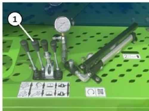
Fig. 63. Levier de commande du convoyeur
