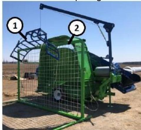
Figure 15. Butée arrière avec grappin
