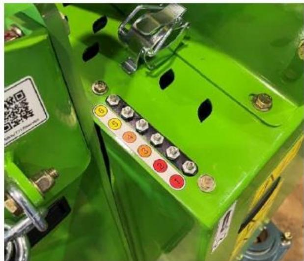
Figure 140. Rampe de graissage
