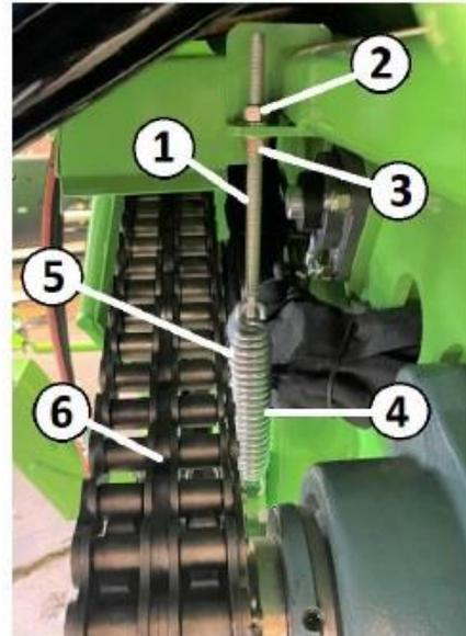
Figure 129. Tension de la chaîne d'entraînement du rotor
