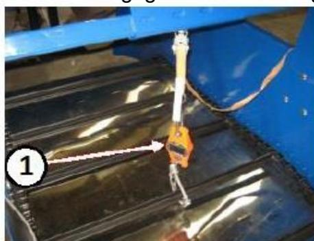
Fig. 125. Tension de chaîne du convoyeur
