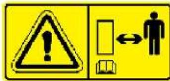
Autocollant de sécurité (2). Cet autocollant concerne l'absence de gardes, couvercles ou autres composants. Restez éloigné de cette zone et remplacez les composants manquants avant d'utiliser. Voir le manuel d'utilisation et les listes de pièces pour déterminer les composants manquants et remplacez-les. Le non-respect de l'avertissement peut causer de graves blessures.
