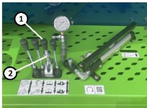
Figure 70. Levier du nettoyeur de tunnel
