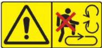
Autocollant de sécurité (4). Danger - Pièces mobiles et en rotation. Cet autocollant concerne les pièces mobiles et en rotation. Tenez toute partie du corps et de vêtement à une distance sécuritaire de la machine en marche. Ne montez pas sur la machine. Arrêtez la machine avant de faire l'entretien de la machine.
