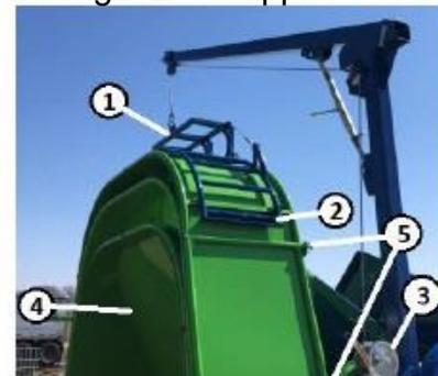
Figure 34. Levage de la rallonge du tunnel
