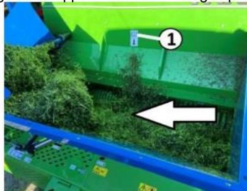
Figure 119. Débit de fourrage optimal au centre
