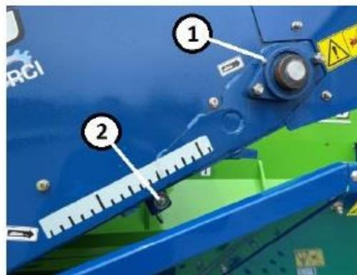
Fig. 143. Graissage du roulement supérieur
