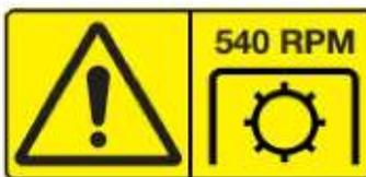
Autocollant de sécurité (12). Cet autocollant avertit de maintenir la vitesse de la PDF à la vitesse prévue de 540 tr/min. Ne faites pas tourner la PDF à plus haute vitesse pour éviter un danger. Le non-respect de cet avis peut causer de graves blessures.
