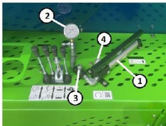
Figure 69. Commande du système de frein
