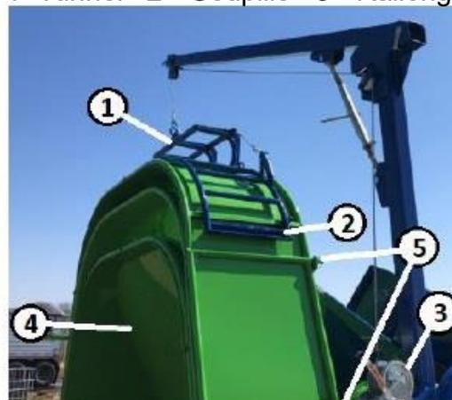
Figure 101. Levage de la rallonge du tunnel
