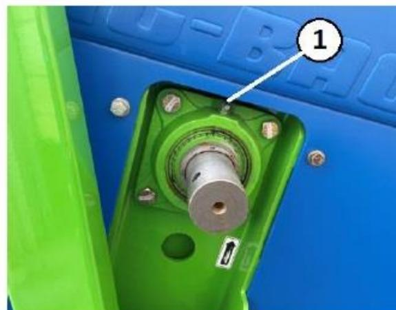
Figure 141. Roulement d'enrouleur de câble
