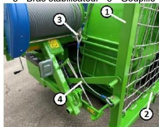
Fig. 105. Butée arrière en position remisée
