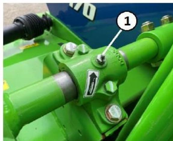
Figure 142. Coussinet d'enrouleur de câble
