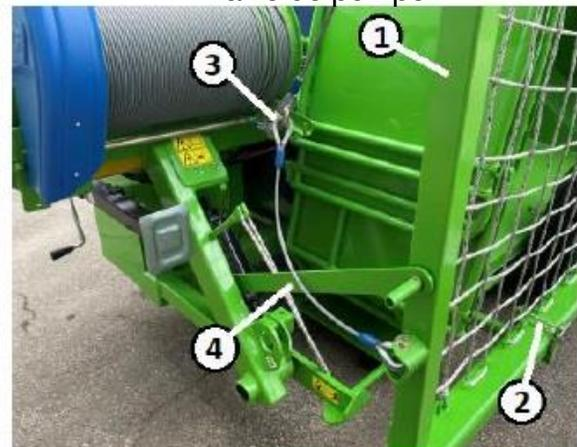
Figure 13. Butée arrière en position remisee
