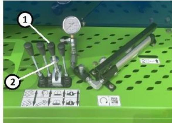
Figure 61. Levier de nettoyage du tunnel
