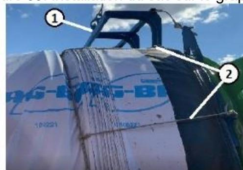
Figure 40. Cordons élastiques de retenue (montrés en position finale)
