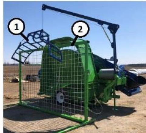
Figure 103. Butée arrière et grappin
