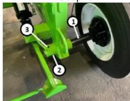
Figure 25. Installation de la fusée d'essieu pour la position de travail (ensachage)
