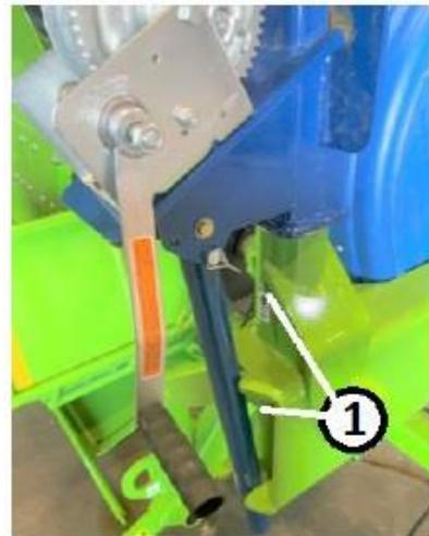
Figure 153. Graissage du pivot de la flèche de levage
