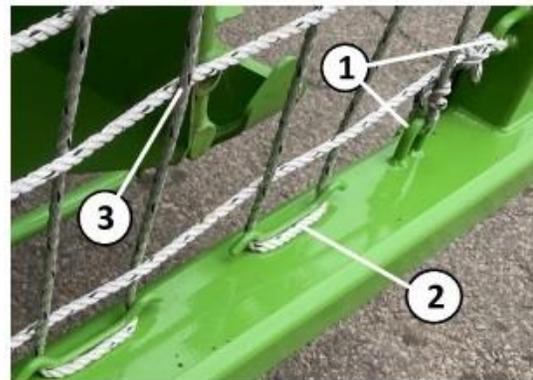
Figure 180. Corde de butée arr. installée
