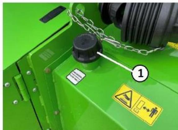
Fig. 155. Bouchon du réservoir d'huile hydraulique
