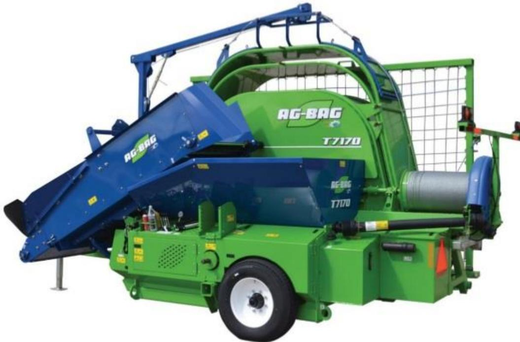
Les ensacheuses traînées Ag-Bagger T7170 et T7060 possèdent une capacité supérieure et plusieurs améliorations d'utilisation. Celles-ci répondent aux attentes des clients et des concessionnaires. Le modèle T7170 est offert avec tunnel de 9 ou 10 pieds (2,74 ou 3,05 m). Le modèle T7060 est offert avec tunnel de 6 pieds, 8 pieds ou 9 pieds (1,83 m, 2,44 m ou 2,74 m).
