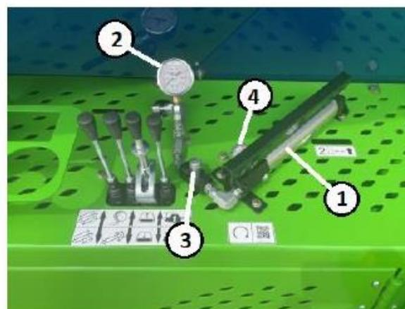
Figure 67. Commande du système de frein
